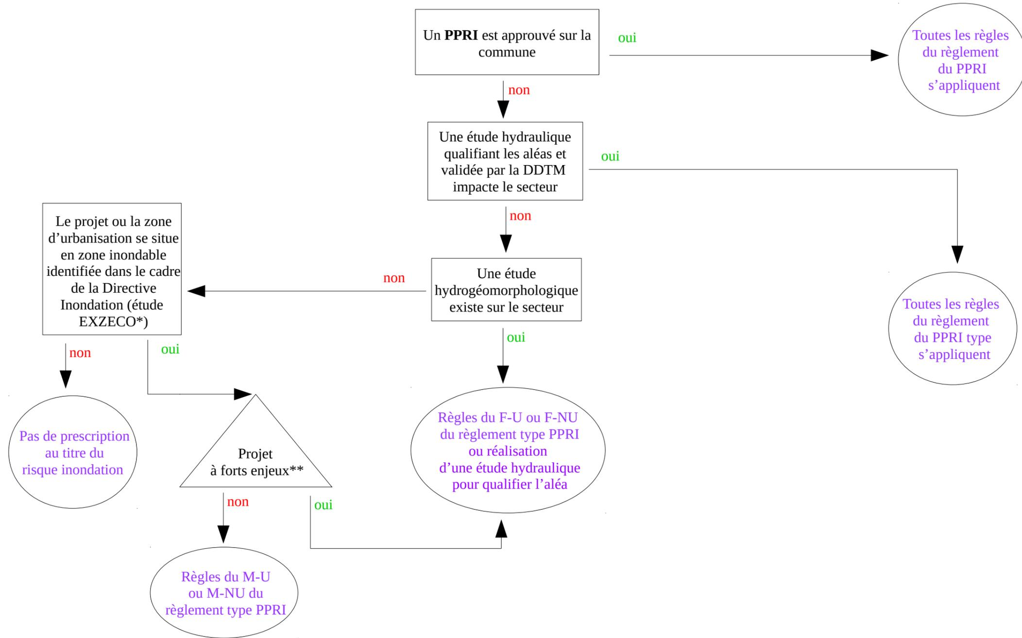
\*EXZECO : EXtraction des Zones d'ECOulement, étude réalisée par le CEREMA à une grande échelle dans le cadre de la Directive Inondation basée essentiellement sur la topographie, qui permet d'identifier des zones potentiellement inondables
